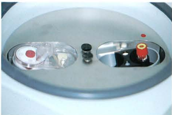
図11 SmartPrepの回転テーブルの所定の位置に、チャンバーを装填する。採取管はATアダプターにセットし、カウンターバランスとしてもう一方の回転テーブルに装填する。 注) 回転テーブル内に装填後、そのまま30分間放置する。これは血球成分(赤血球、白血球、血小板)が十分に沈殿するのに30分は必要である。すぐに遠心分離を行うとトロンビンの消費が大きく、採取できる量が減少する。30分間放置後、スタートボタンを押して、13分間の遠心分離処理を行う。
